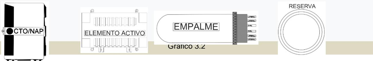
Caja terminal óptica – Nodo óptico/Amplificador – Empalme por inserción – Exceso de ganancia (bucle o reserva final).
