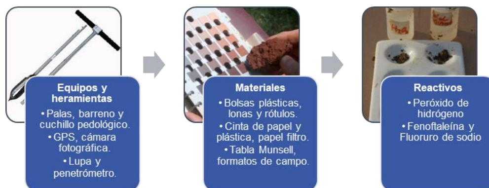
Figura 2-13 Materiales, equipos y herramientas utilizados en campo
