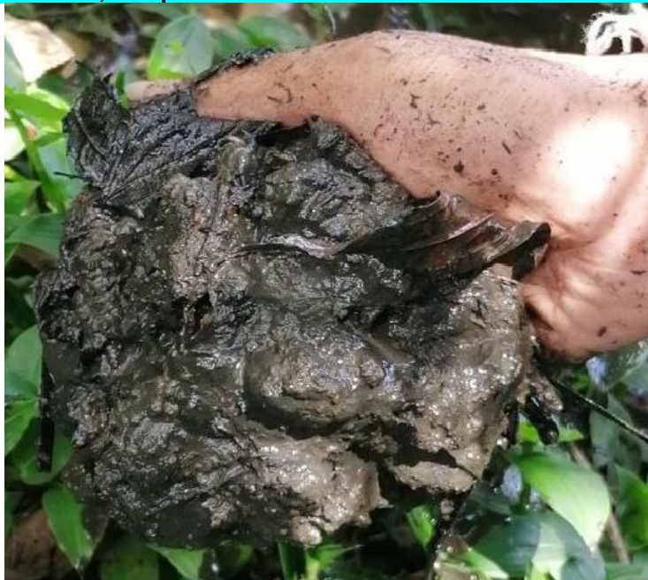
Figura 7-33 Material tomado del Drenaje Canal Guaymaral que hace parte de los depósitos de la Formación Sabana, composición textural identificada al tacto 85% limo y 15% arcilla
