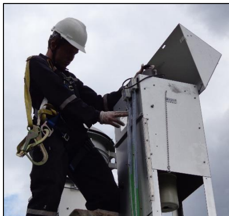
Fotografía 1-1 Equipo Hi-Vol para determinación de Partículas Suspendidas Totales
