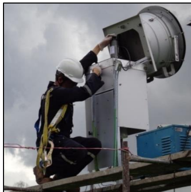
Fotografía 1-2 Equipo muestreador de PM 10
