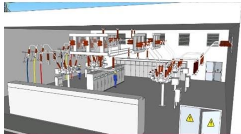
Montaje electromecánico subestación
