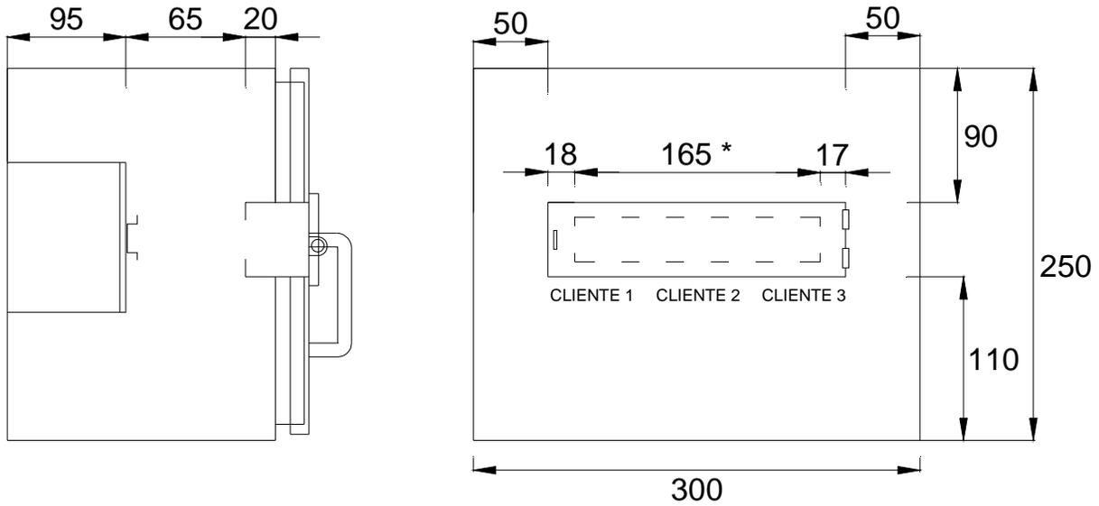
**FIGURA 7 BUJE DEL SISTEMA DE SEGURIDAD**
