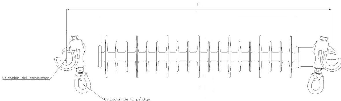
Figura 1. Forma del separador de fases
