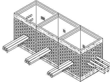
CAJA DE INSPECCIÓN TRIPLE PARA CANALIZACIÓN
