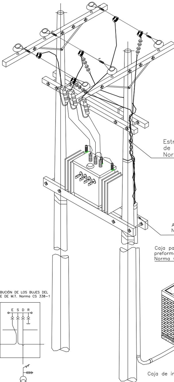
Estructura tipo H para Montaje de transformador trifásico Norma CTU 503 o CTU 504
