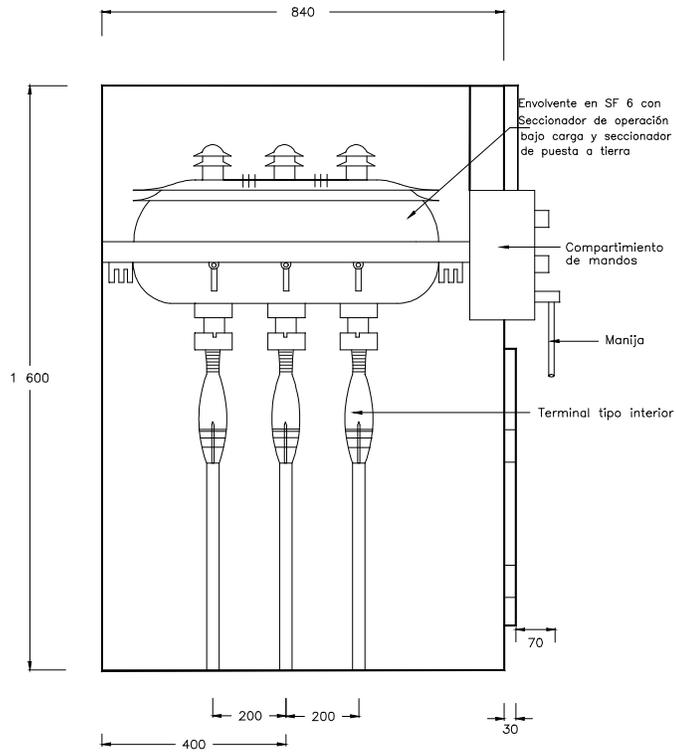
SECCIONADOR EN SF6 DE PROTECCIÓN 17.5 kV
