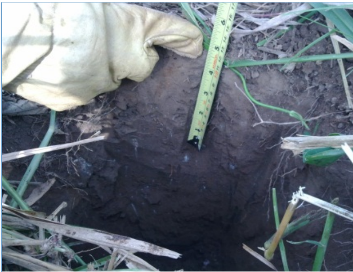
Fotografía: Realización de apiques en la zona 14 A, para verificar la presencia de capa orgánica en el área de trabajo.
