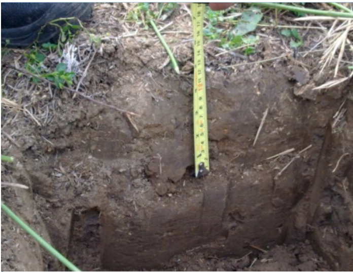
Fotografía: Realización de apiques en la zona 14 A, para verificar la presencia de capa orgánica en el área de trabajo.
