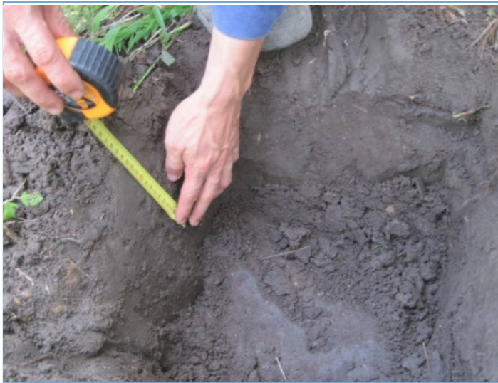
Fotografías: Realización de apiques para verificar presencia de la capa orgánica - zona de explotación 21.
