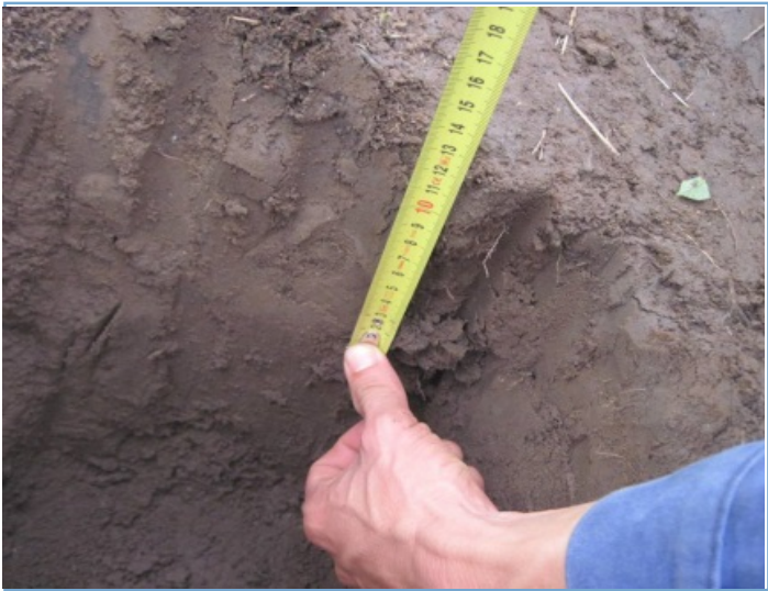
Fotografías: Realización de apiques para verificar presencia de la capa orgánica - zona de explotación 21.
