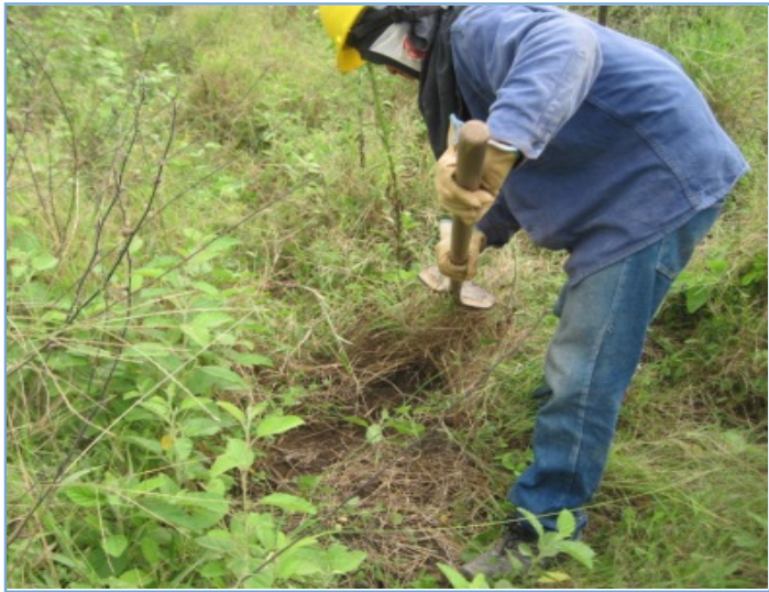
Fotografía: Realización de apiques en la zona 21, para verificar la presencia de capa orgánica, dentro del área de trabajo.
