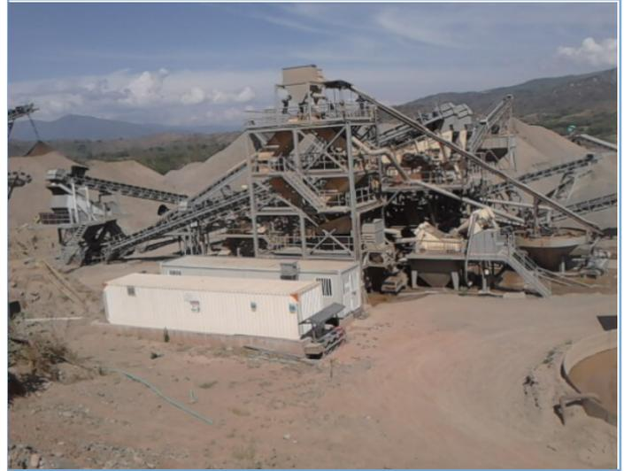
Protección en bandas transportadora de materiales, evita la fricción del viento para disminuir la emisión de material particulado en la trituradora.
