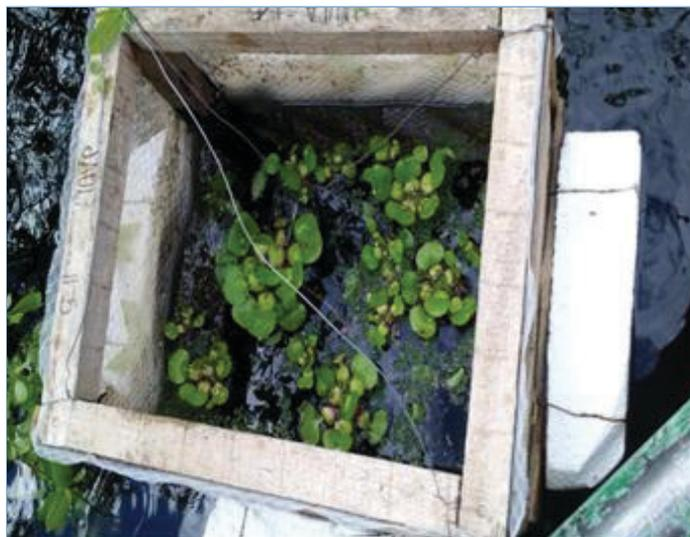
Instalación de ensayos para determinar tasa de crecimiento de macrófitas.
