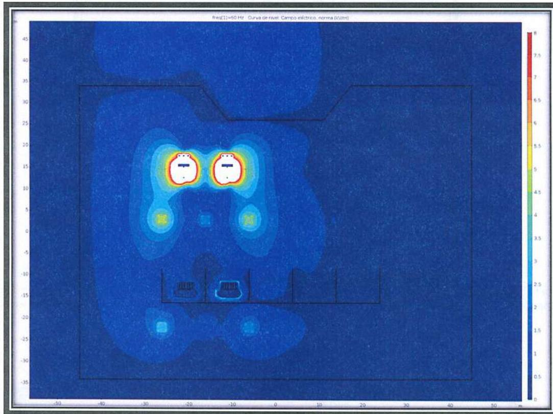
**Figura 11.** Intensidad de Campo Eléctrico al interior de la Subestación Terminal y Alrededores [kV/m]. Los niveles de intensidad de campo eléctrico alrededor de la subestación son inferiores a 2 kV/m, cumpliendo lo establecido por el Reglamento Técnico de Instalaciones Eléctricas – RETIE.
