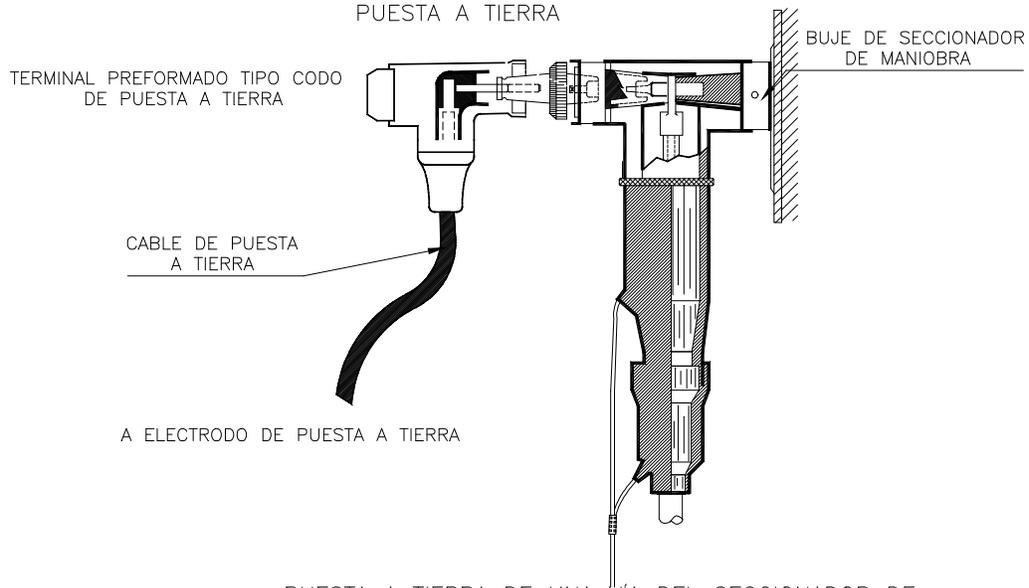
PUESTA A TIERRA DE UNA VÍA DEL SECCIONADOR DE
