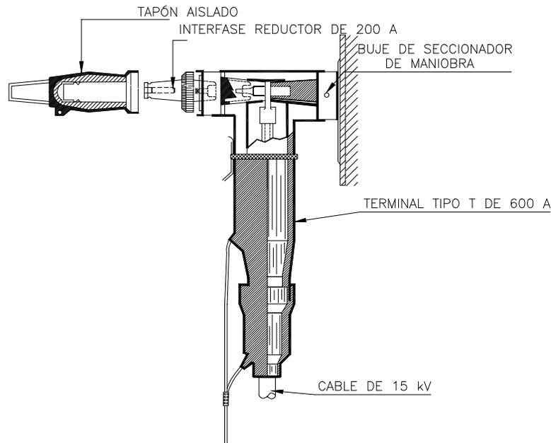
CODO PREMOLDEADO 600 A-15 kV
